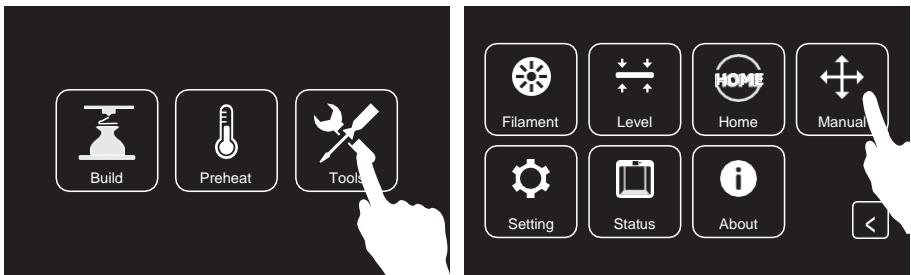
11. 取出电源线，插入打印机背部的电源线接口。通电后打开电源开关。开机完成后，在触摸屏上依次点击[Tools]、[Manual]进入手动控制界面。
