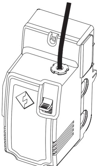
6. 将导丝管插入喷头进丝孔中固定。
