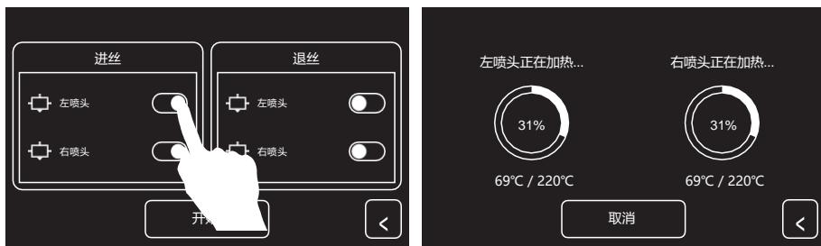
2. 点击[进丝]。点击对应喷头后面的开关按钮来选择该喷头是否执行进丝操作。
