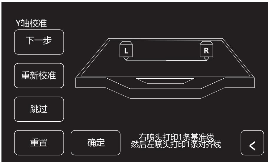
1. 点击[Y轴校准]，等待两个喷头加温。加温到目标温度，两个喷头依次打印一条直线。
