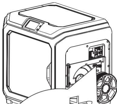
2. 取出耗材，将耗材插入进丝口中。
