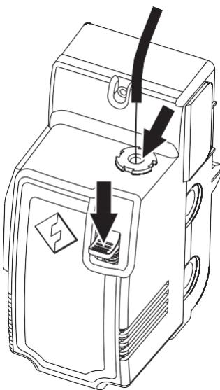
5. 按下喷头前方的进丝压板，将耗材垂直插入喷头，直到无法继续插入。松开进丝压板。
