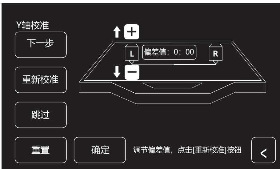
2. 若两条线没有完全重合，点击[否]。根据实际情况调整喷头位置。调整结束后，清理打印平台上的耗材，并点击[重新校准]；重复上述步骤，直至打印的两条直线完全重合。
