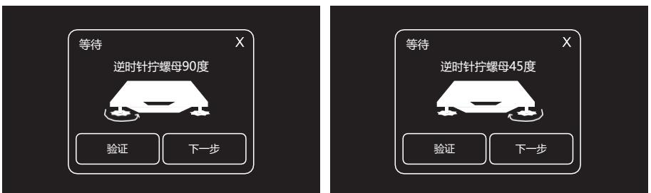
4. 在第二和第三个调平点的距离验证过程中，如果喷嘴和打印平台之间的距离不合适，请根据液晶屏上的提示信息进行相应的操作。第二个调平点验证通过后点击[OK]，进行第三个调平点的调平，同样根据液晶屏上的提示信息进行相应的操作。第三个调平点完成后，调平结束。
