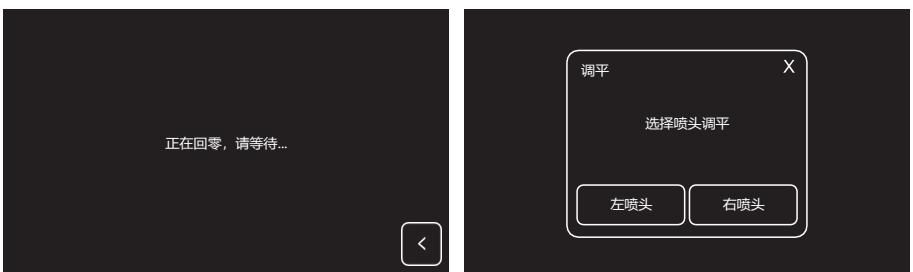
2. 在喷头和打印平台停止运动后，选择使用哪个喷头进行调平。
