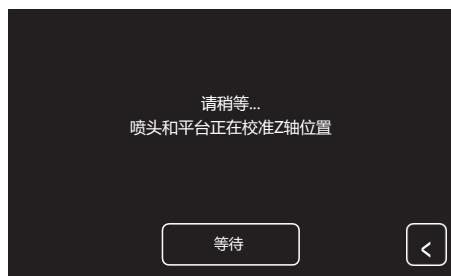
1. 点击触摸屏[Z轴校准]，等待喷头和平台Z轴校准。校准过程中，不要中断。
