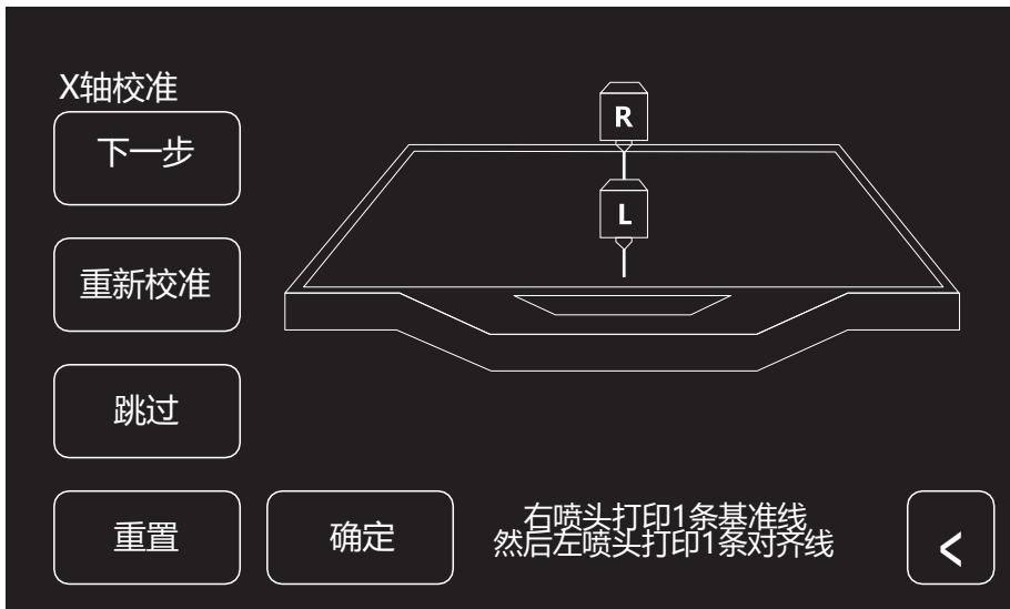
1. 点击触摸屏[X轴校准]，等待两个喷头加温；加温到目标温度，两个喷头依次打印一条直线。打印完毕，检查两条线是否重合；同时，触摸屏弹出确认窗口。
