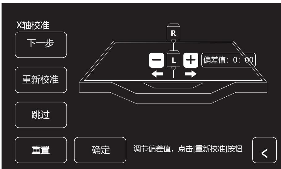
2. 若两条线完全重合，点击[是]，X轴校准完成。若两条线没有完全重合，点击[否]；根据实际情况调整喷头位置。调整结束后，清理打印平台上的耗材，并点击[重新校准]；重复上述步骤，直至打印的两条直线完全重合。
