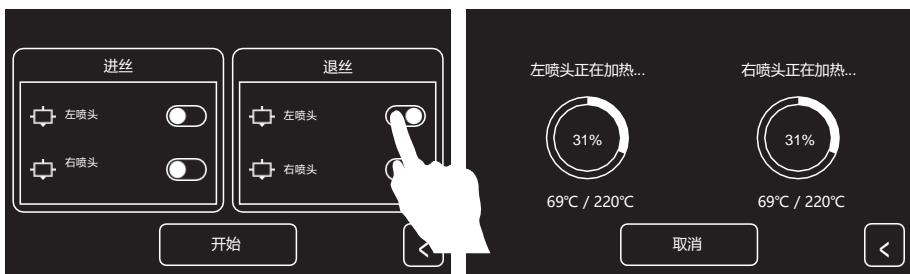
2. 点击[退丝]。点击对应喷头后面的开关按钮来选择该喷头是否执行退丝操作。
